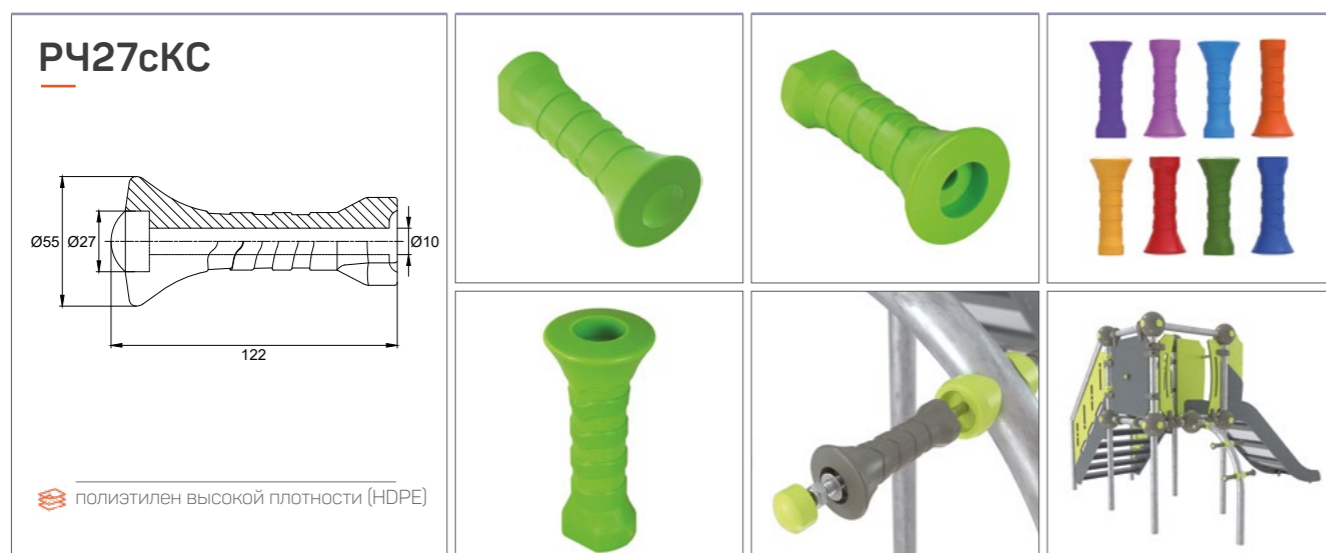
Пластиковая конусообразная ручка под резьбовую шпильку М10. Длина ручки – 122 мм. Изделие используется как захват для рук и упор для ног.
