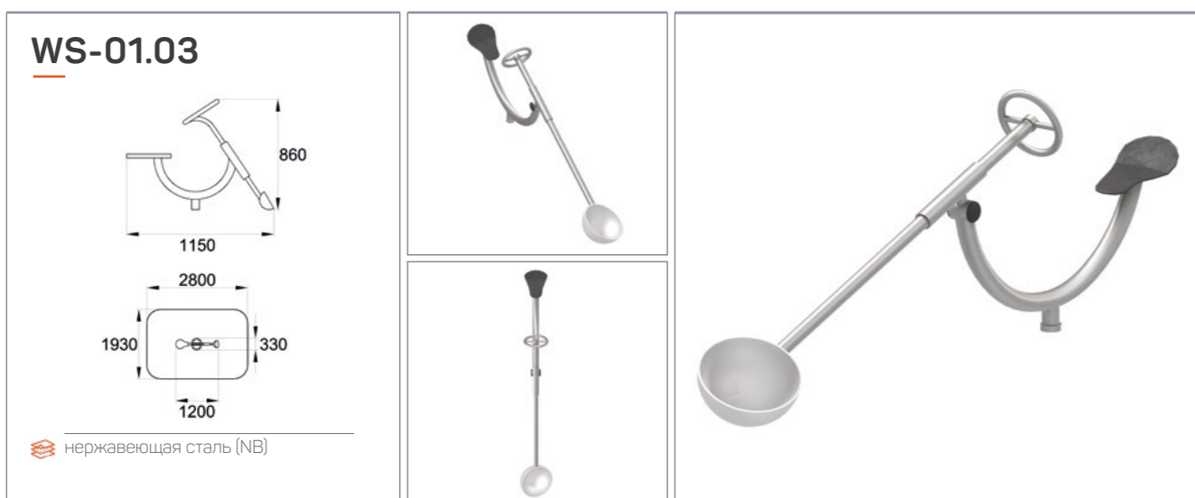
Черпак для воды с сиденьем. Изготовлен из нержавеющей стали. Габариты изделия – 1150x860x330 мм. Используется в составе детских игровых комплексов для игры с водой.
