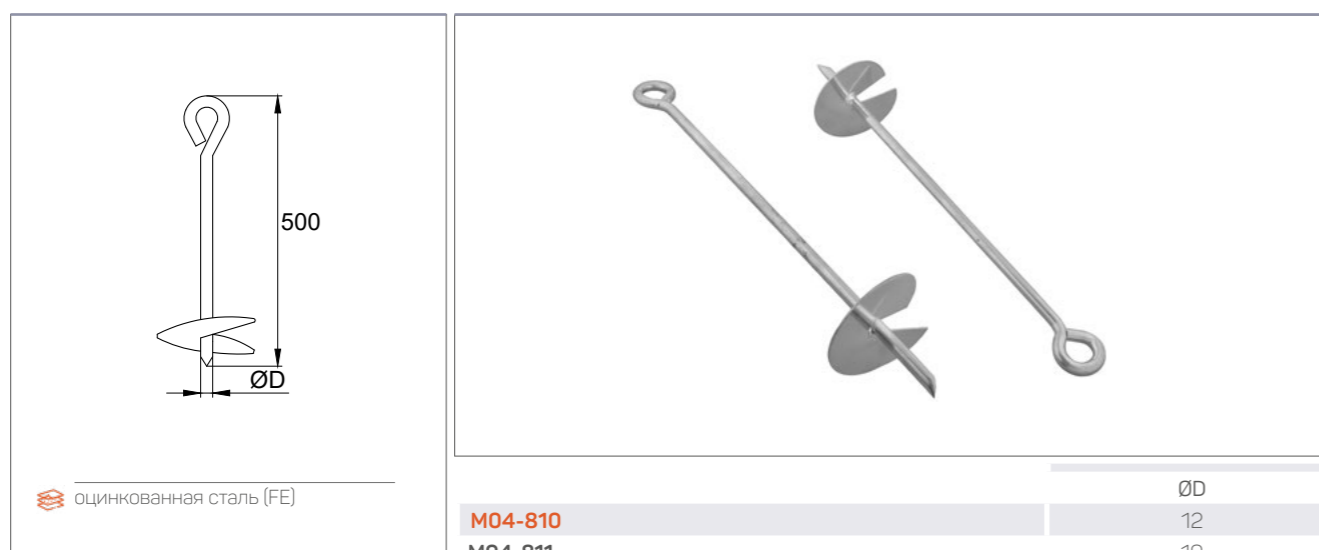
Грунтовый анкер с режущими пластинами. Изготовлен из оцинкованной стали. Толщина изделия может быть 10 или 12 мм. Длина – 500 мм.
