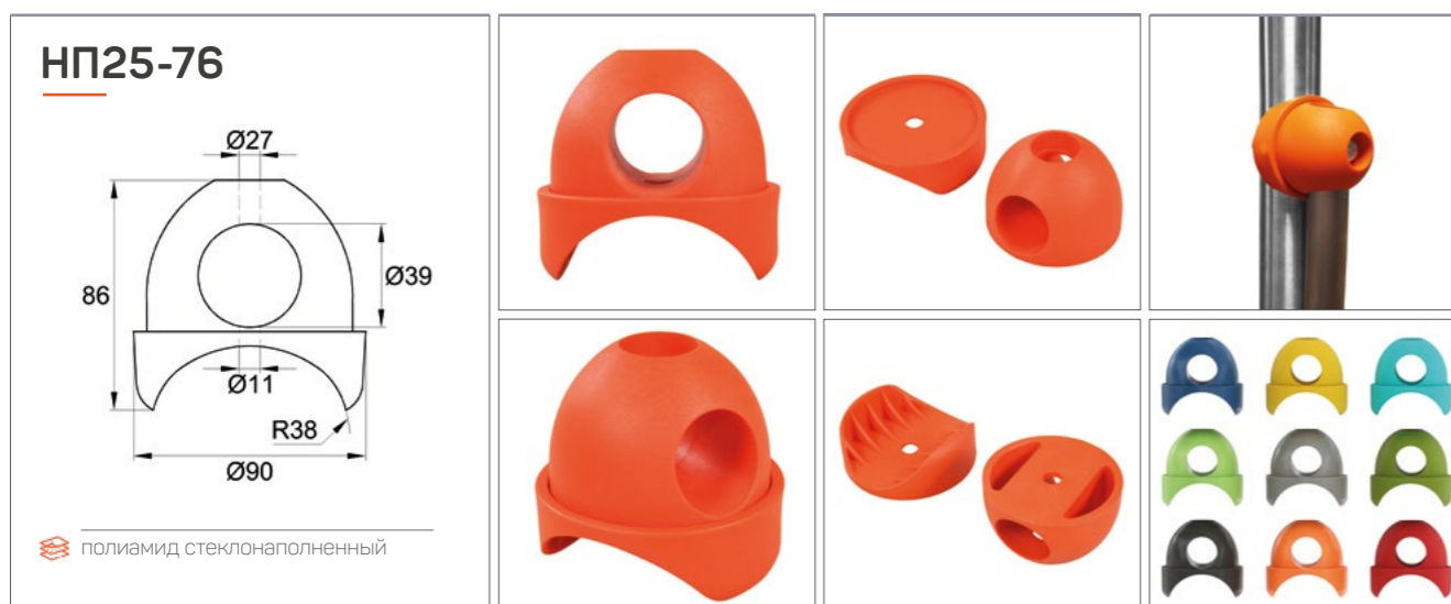
Переходник-накладка с трубы ДУ25 на трубу диаметром 76 мм. Состоит из двух частей. Габариты изделия – 86x90 мм.
