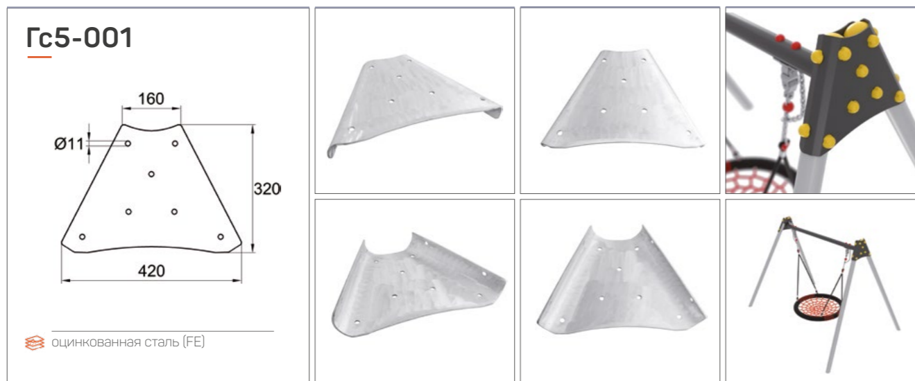
Стальной оцинкованный фланец размером 420x320 мм. Устанавливается в комплекте с обратным фланцем Гс5-002 на трубу Ø76 мм.
