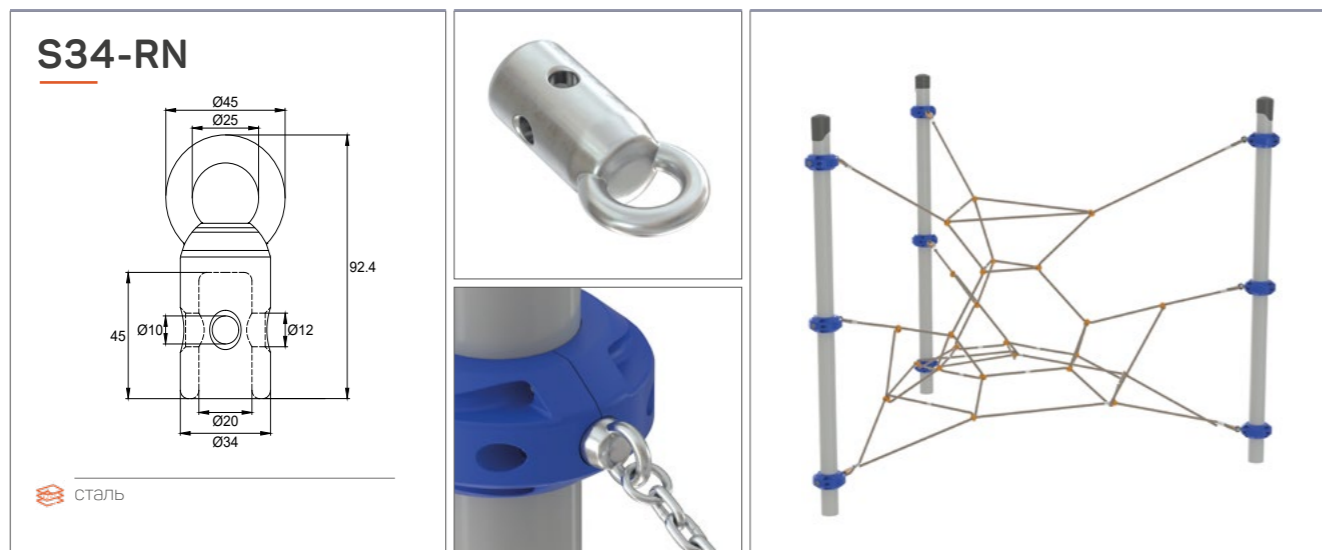
Стальной соединитель с четырьмя отверстиями для фиксации. Крепится к трубе при помощи специального хомута (арт. ХП108-34КС; ХП189-34КС). Длина изделия – 92,4 мм.
