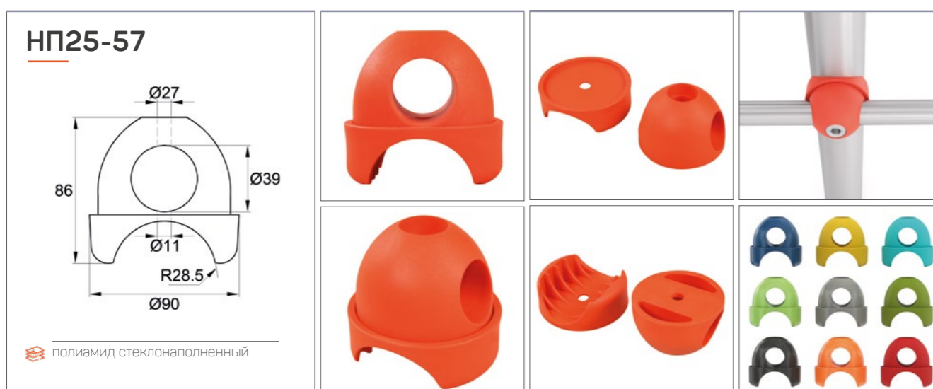
Переходник-накладка с трубы ДУ25 на трубу диаметром 57 мм. Состоит из двух частей. Габариты изделия – 86x90 мм.
