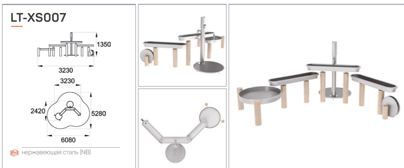
Детский комплекс для игры с водой. Габариты – 3230x1350x2420 мм. Состоит из деревянных столбов и ёмкостей из нержавеющей стали.
