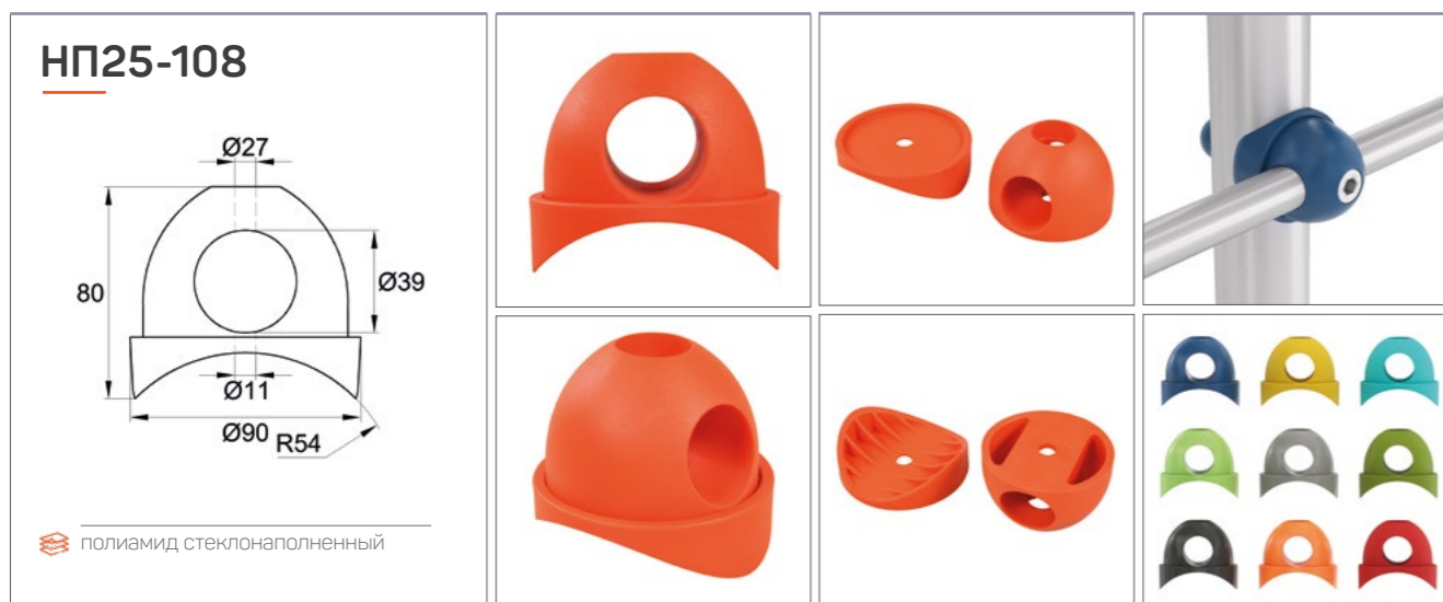
Переходник-накладка с трубы ДУ25 на трубу диаметром 108 мм. Состоит из двух частей. Габариты изделия – 90x80 мм.
