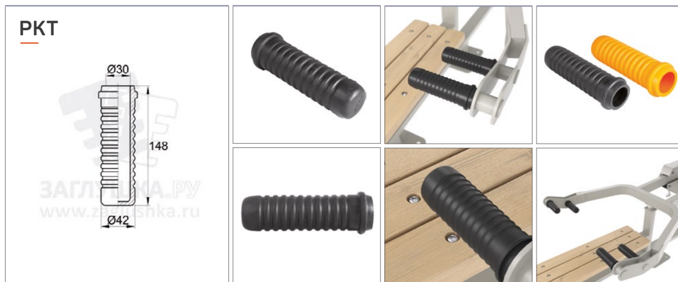
Резиновая рифлёная ручка без сквозного отверстия под трубу Ø30 мм. Длина изделия – 148 мм.
