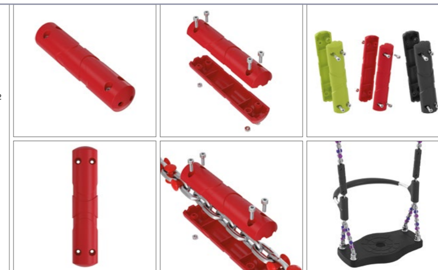
Пластиковая ручка для установки на стальную круглозвенную цепь 6x19 мм (DIN766). Длина изделия – 150 мм. Диаметр отверстий для крепления – 4 мм.
