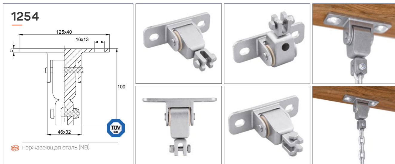
Крепление из нержавеющей стали для установки подвесных качелей. Крепится к поверхности при помощи двух болтов М12.
