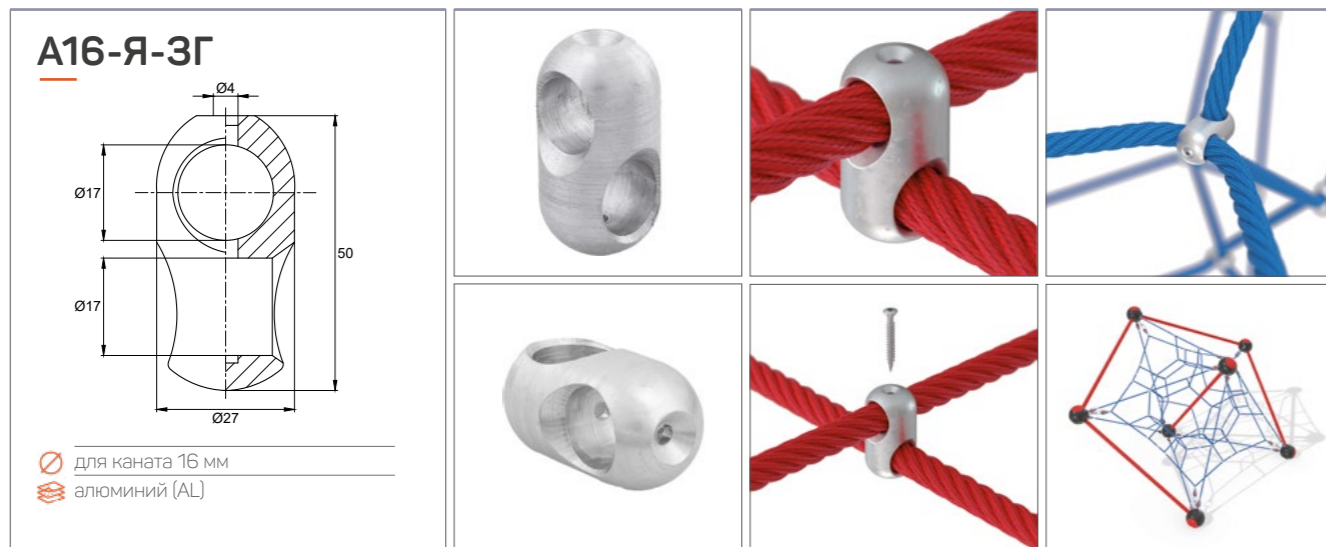
Алюминиевый соединитель для канатов Ø16 мм. Предназначен для крестообразной фиксации канатов при производстве детских конструкций для лазанья. Не используется под обжим.
