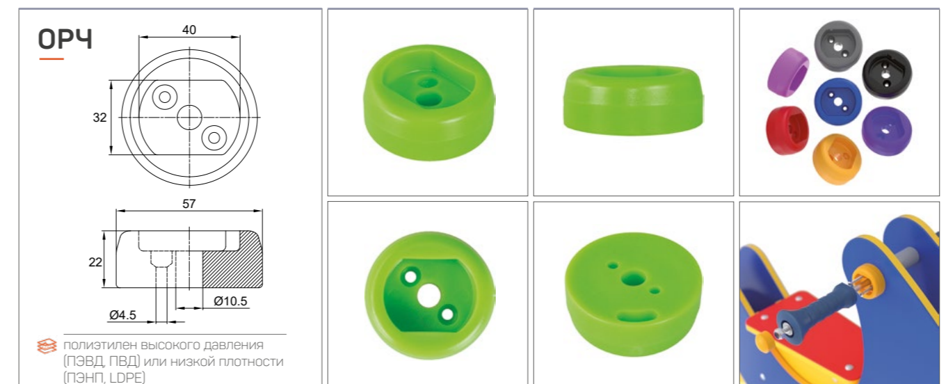
Пластиковая вставка в ручку. Диаметр изделия – 57 мм. Применяется в комплекте с конусообразной ручкой (арт. РЧ27КС).
