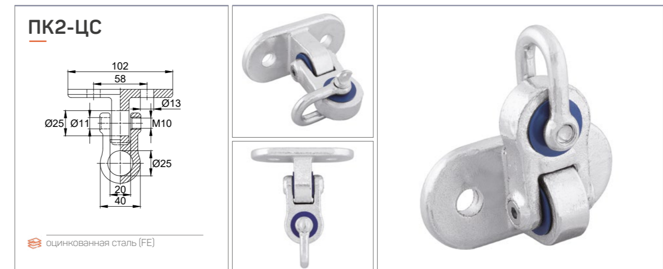
Поворотный подвес из оцинкованной стали. Имеет пластиковые втулки с внутренним Ø10 мм. Крепится к поверхности при помощи двух болтов M12.
