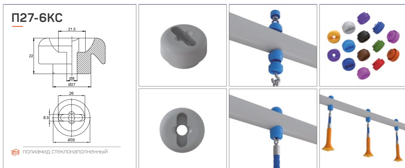
Пластиковая вставка в ручку. Предназначена для крепления к цепи с толщиной звена 6 мм. Изделие устойчиво к выцветанию и влаге.
