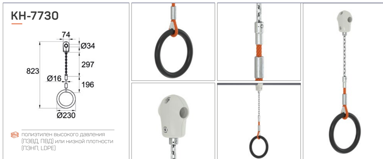
Гимнастическое кольцо с подвесом. Длина изделия – 823 мм, внешний диаметр кольца – 230 мм, внутренний диаметр – 175 мм.
