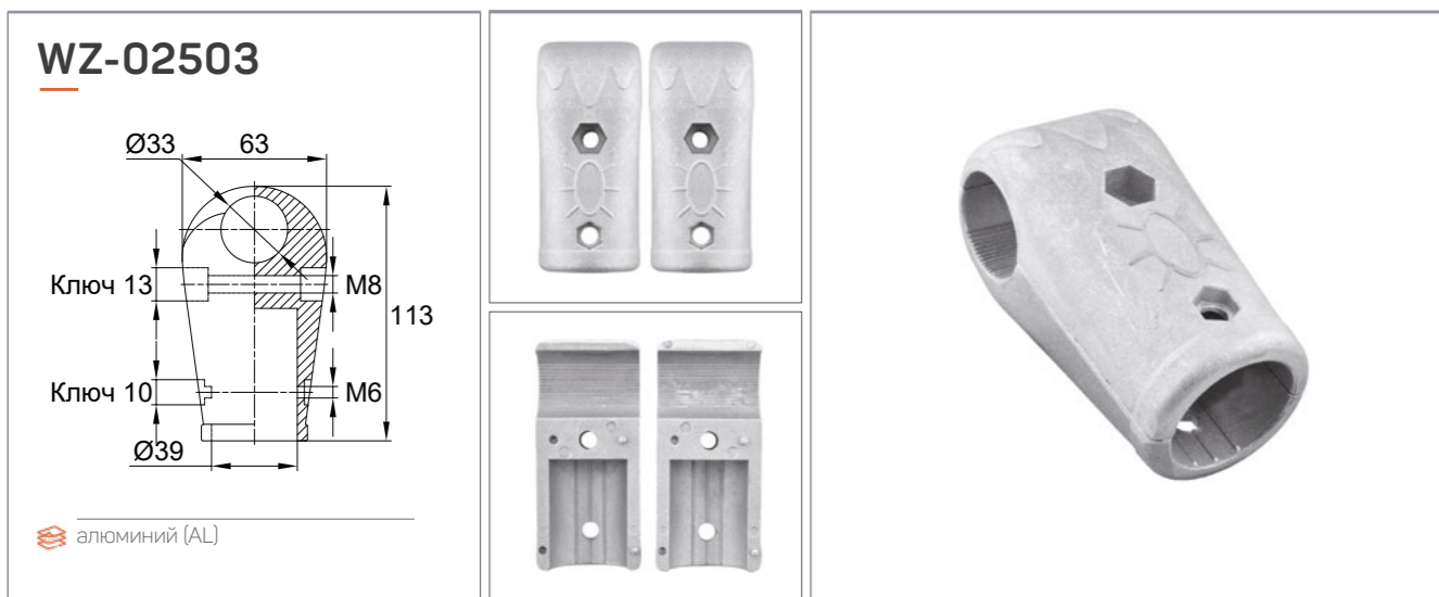
Алюминиевый хомут для соединения двух труб Ø34 мм.
