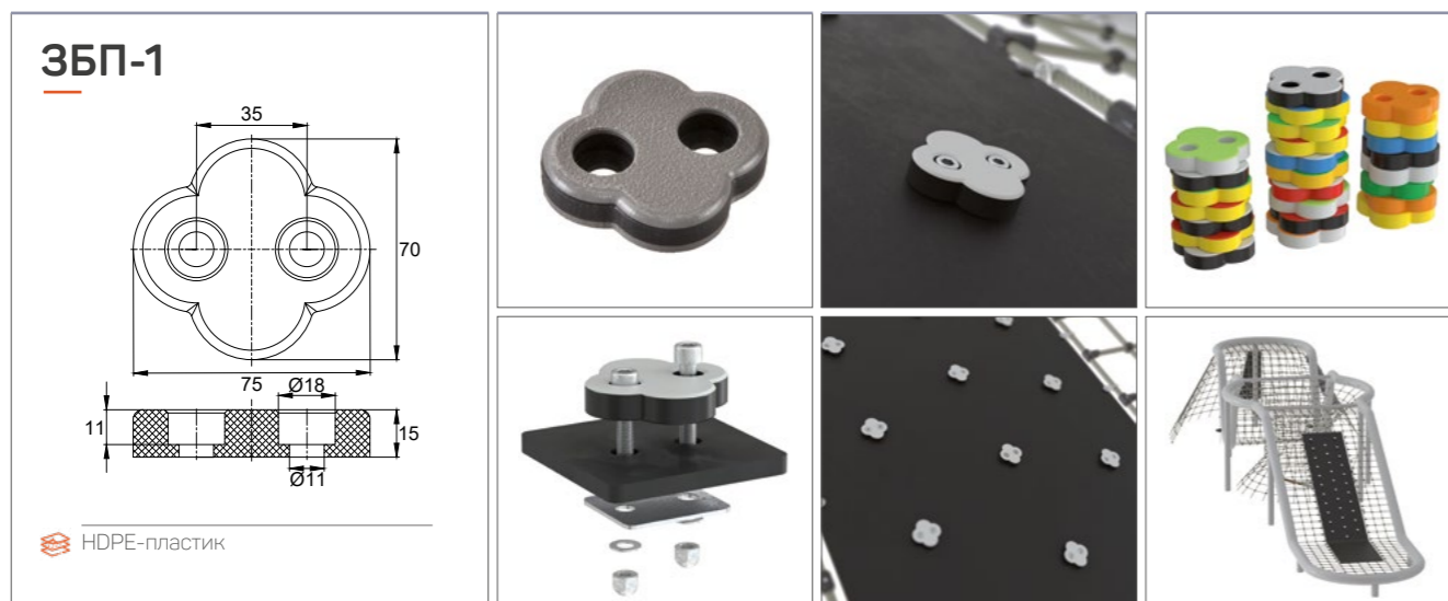
Пластиковый зацеп лепестковой формы для скалодрома. Габариты – 75x70x15 мм. Крепится с помощью винта М10.
