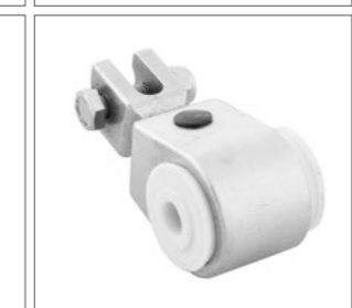
Универсальное крепление из нержавеющей стали для качелей. Используется совместно с П-образным кронштейном. В комплект поставки входят полиамидная вставка и крепежная фурнитура из нержавеющей стали: болт DIN933 M8x30 и гайка DIN985 M8.
