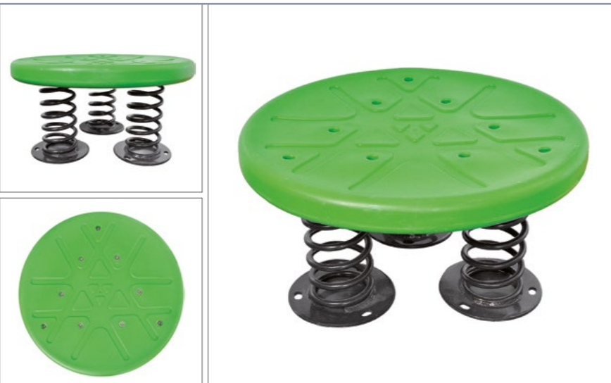
Балансир круглой формы на трёх пружинах. Диаметр платформы – 800 мм, высота конструкции – 420 мм.
