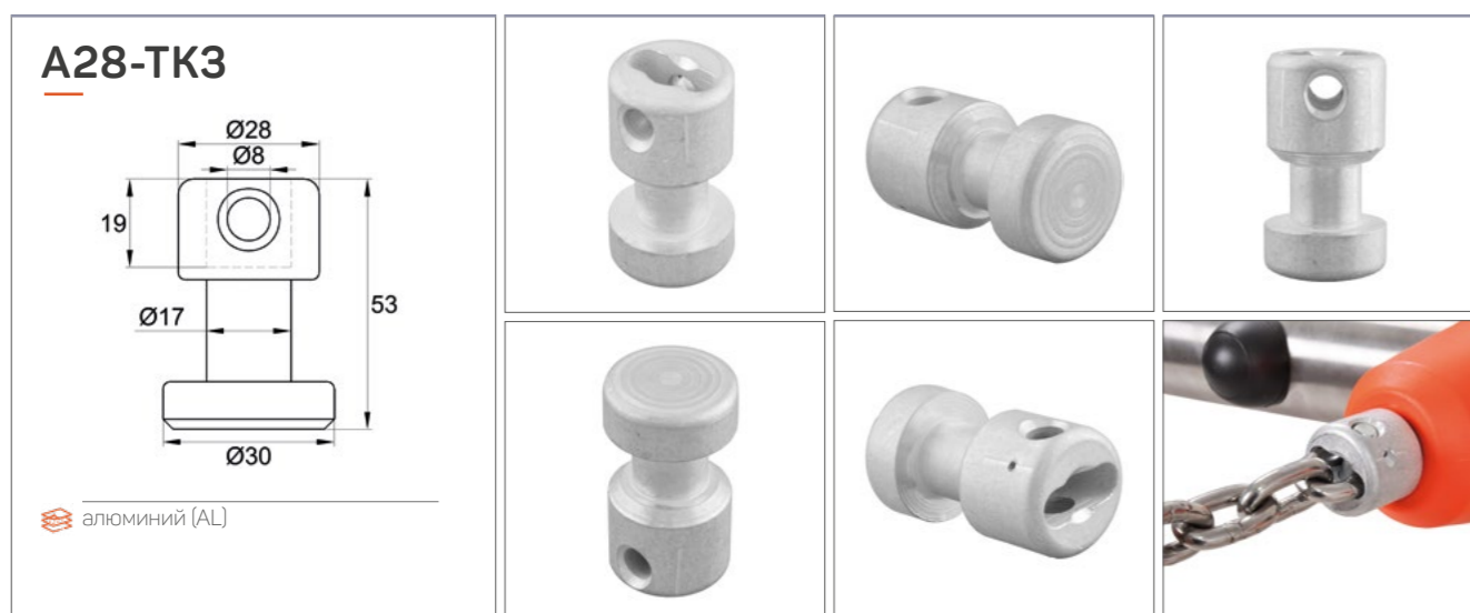
Металлический соединитель цепи и хомута. Изготовлен из алюминиевого сплава. Размер изделия – 30x53 мм.
