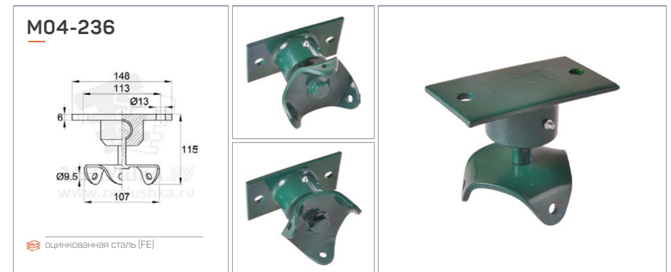
Шарнирный подвес для установки качелей. Покрит порошковой краской зелёного цвета. Габариты – 115x148 мм.
