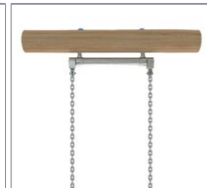
Адаптер из нержавеющей стали с полиамидной втулкой. Резьба – M12x175мм. Поставляется в сборе с рым-болтом М8 (арт. KTSEB)
