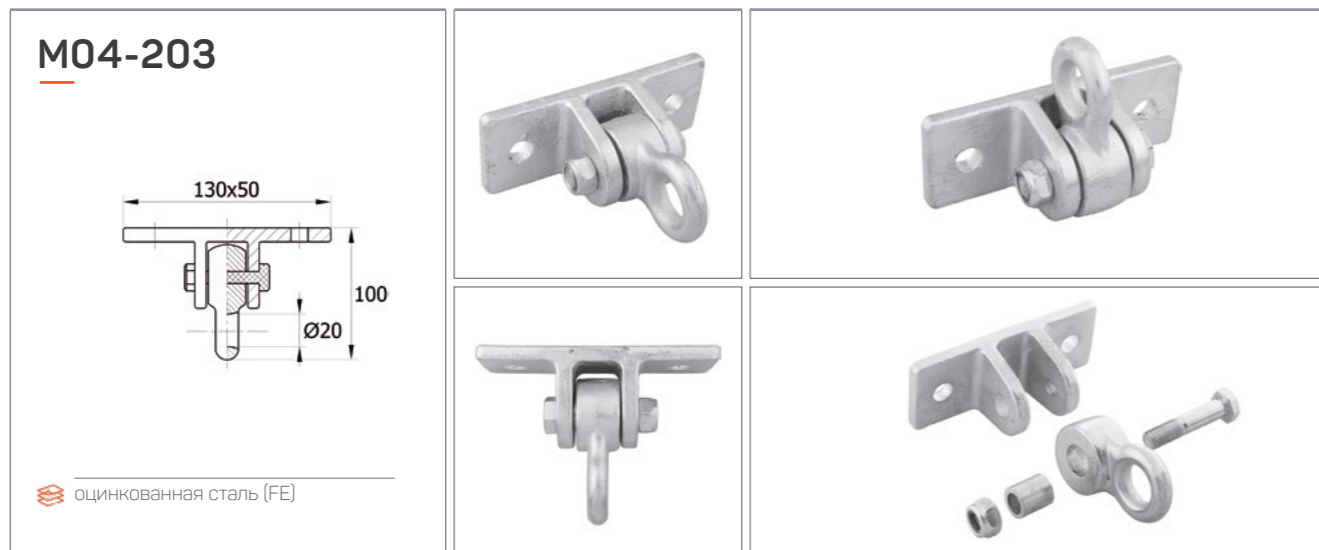
Крепление из оцинкованной стали для подвесных качелей. Диаметр кольца составляет 20 мм.
