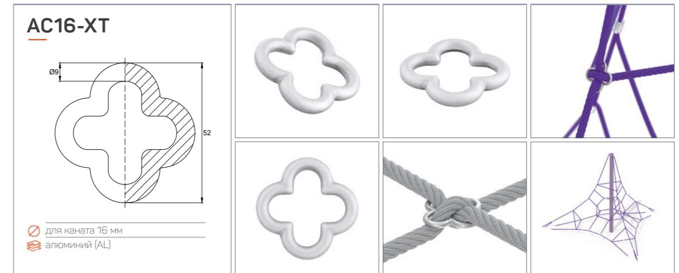
Алюминиевый соединитель типа «клевер» для двух канатов Ø16 мм. Фиксирует канаты перпендикулярно по расположению друг к другу.
