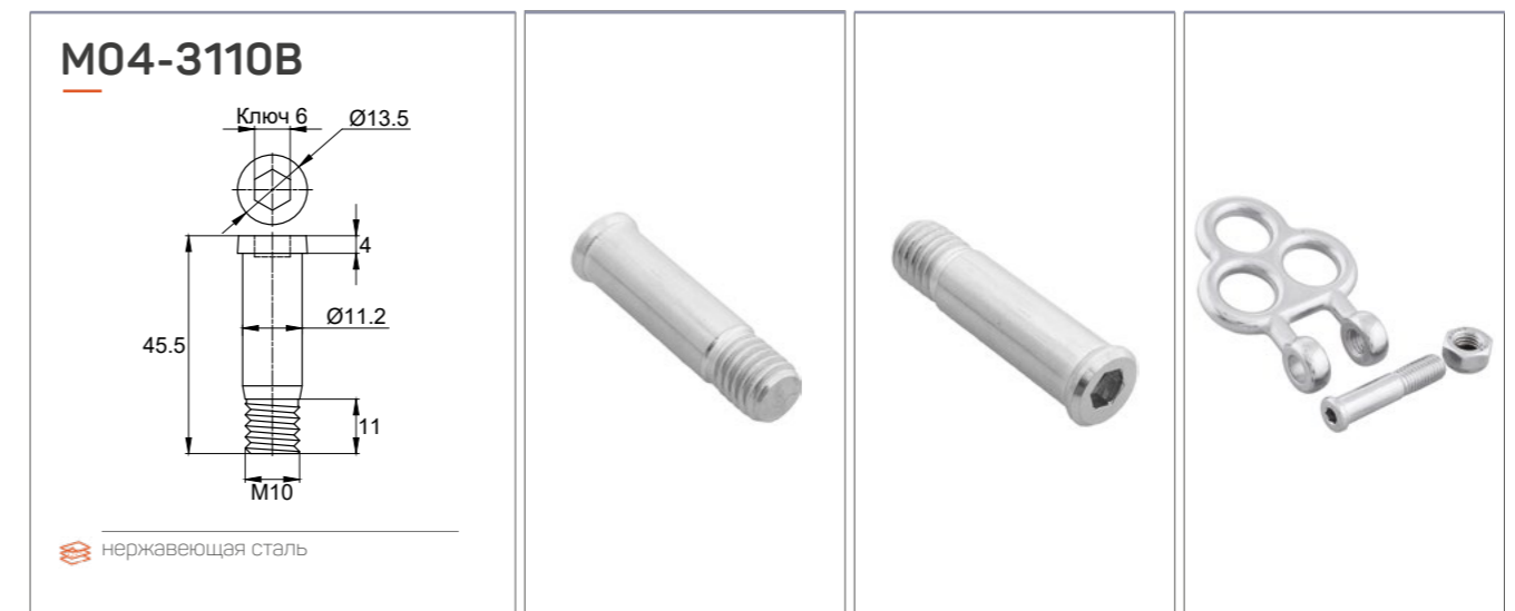
Винт M10x11 мм к скобе M10 (арт. M04-3110). Изготовлен из нержавеющей стали.
