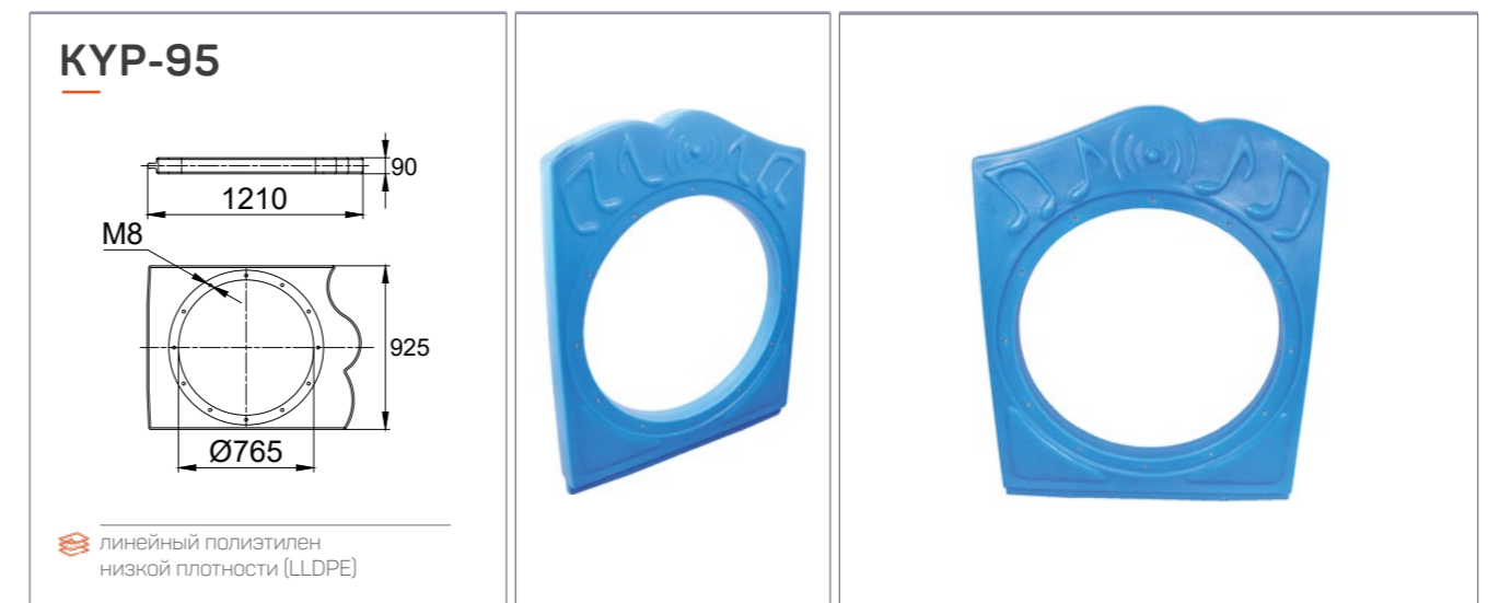
Пластиковая панель для тоннельных горок с круглым отверстием Ø765 мм. По краям изделия расположены крепёжные резьбовые отверстия под болты М8.
