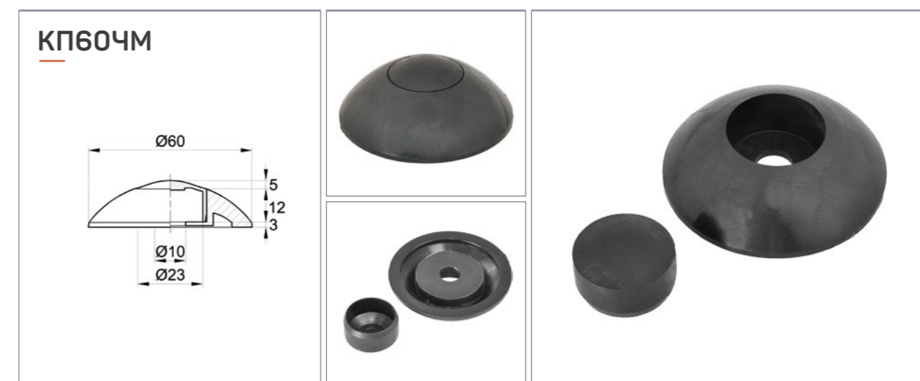
Составной колпачок для подшипника уличного тренажёра. Диаметр изделия – 60 мм.
