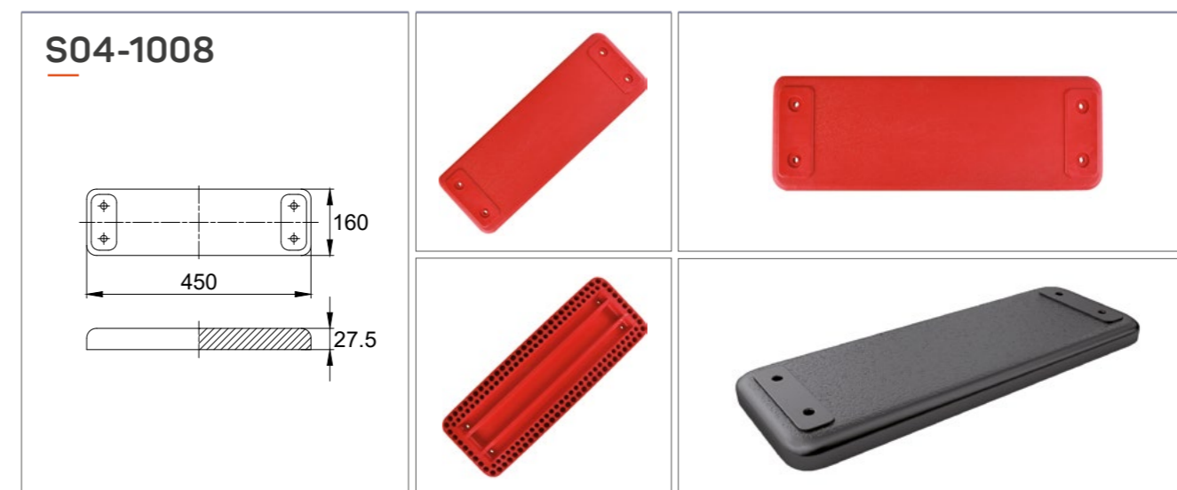
Сиденье для качелей. Габариты — 450x27.5x160 мм. Изделие имеет четыре сквозных отверстия для крепления подвесов. Подвесы в комплект поставки не входят.
