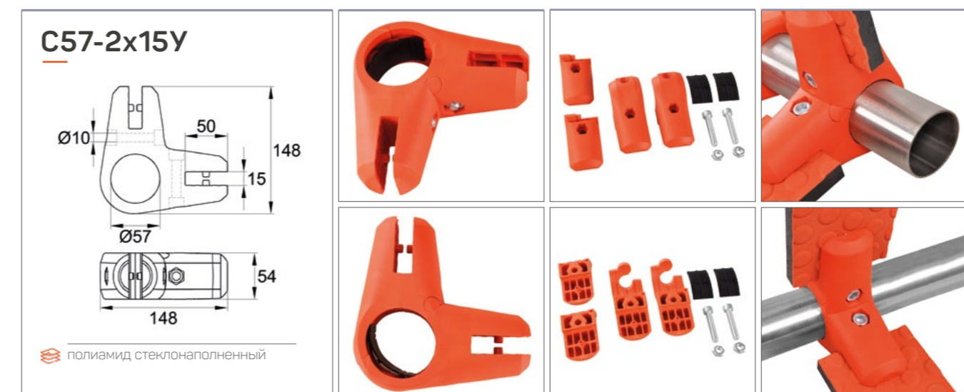
Угловой пластиковый хомут для крепления трубы диаметром 57 мм к двум листовым материалам толщиной 15 мм. Размер изделия – 148x148x54 мм.
