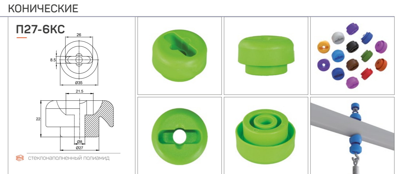
Пластиковая вставка в ручку для крепления к цепи с диаметром прутка 6 мм. Диаметр изделия – 35 мм.
