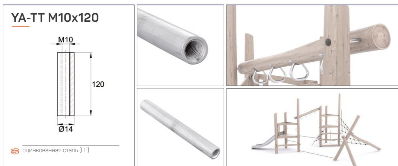
Стальной оцинкованный подпятник под оцилиндрованный брус. Габариты – 120x14 мм.
