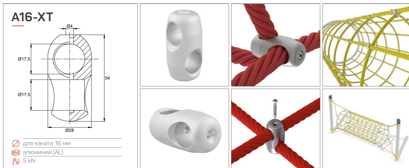
Алюминиевый соединитель для канатов Ø16 мм. Используется в канатных конструкциях типа «Пирамида», а также в крупных нагруженных сетках. Максимальная нагрузка на соединение — 5 kN.
