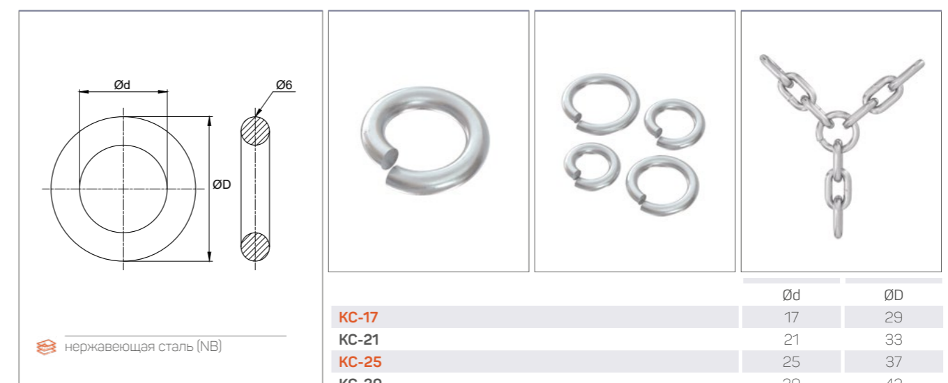
Соединительное кольцо из нержавеющей стали. Имеет разъёмное соединение для цепей с диаметром прутка 6 мм. Диаметр изделия может быть 17, 21, 25 и 30 мм.
