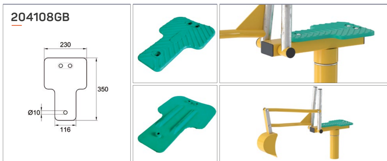
Пластиковое сиденье для балансера. Габариты – 350x230 мм. Изделие предназначено для крепления к круглой поверхности диаметром от 100 до 200 мм.
