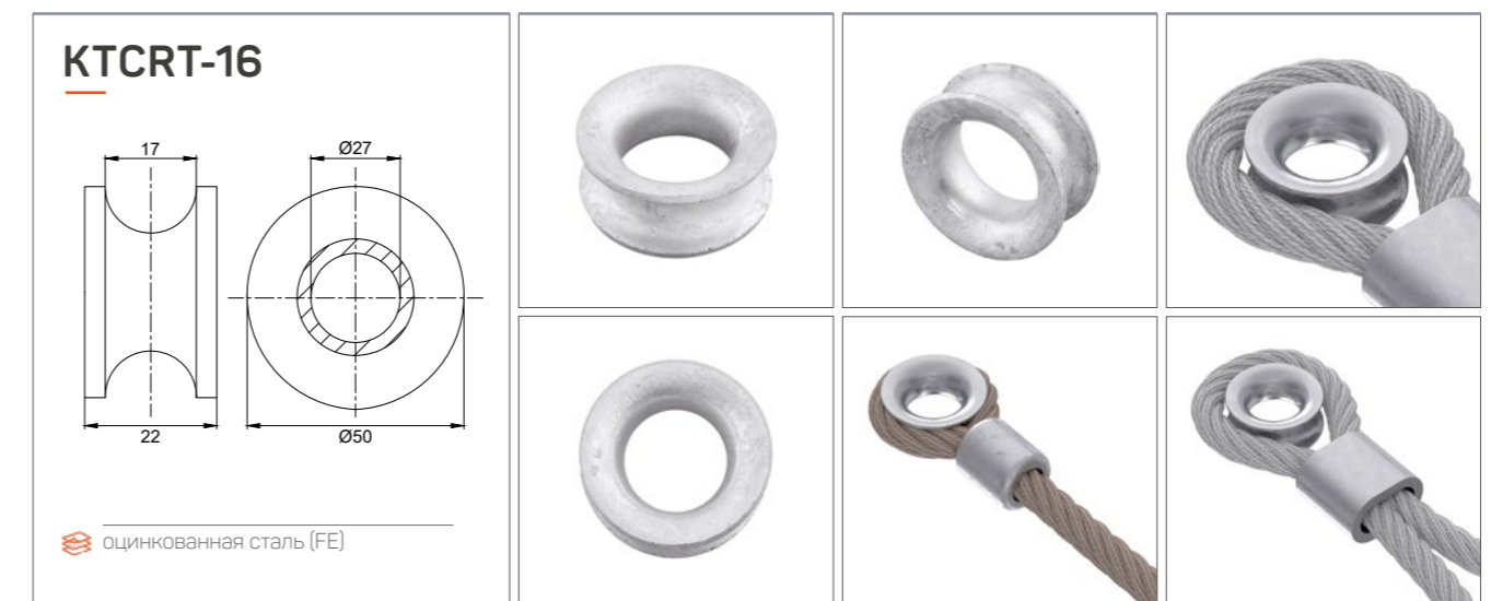
Круглый коуш для каната Ø16 мм. Изготовлен из оцинкованной стали. Предназначен для создания канатных петель. Используется вместе с канатом и обжимной гильзой.
