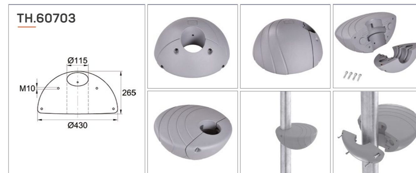
Пластиковый уступ для установки на трубу Ø114 мм. Габариты изделия – 430x265 мм. Крепится болтами М10.
