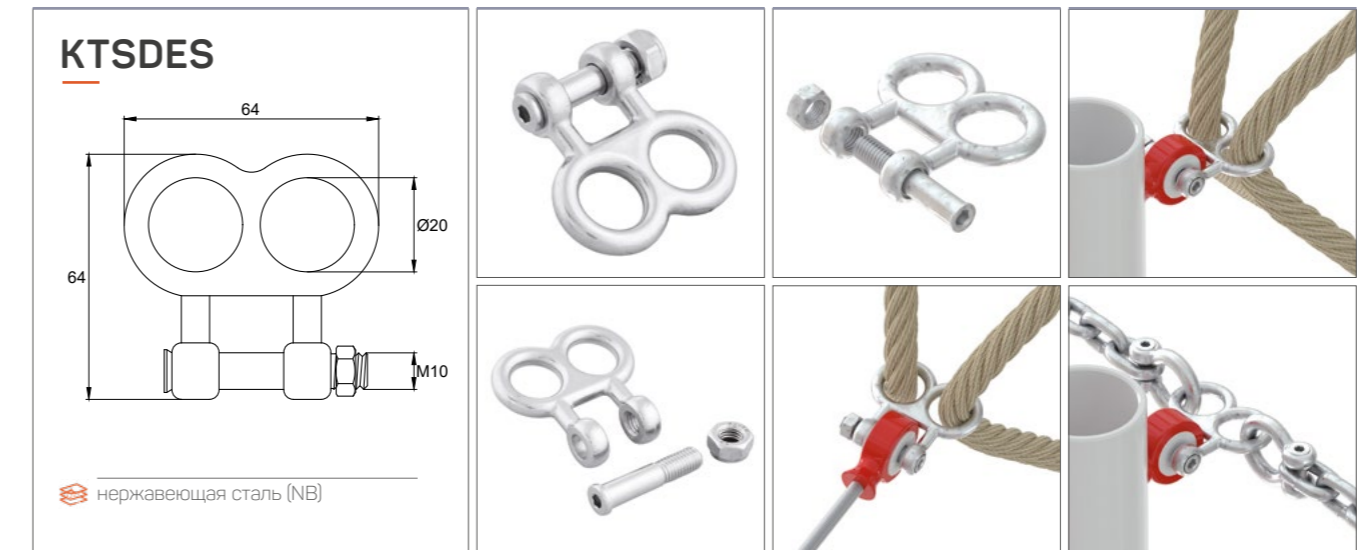
Двойной соединитель для канатов «кольцо-скоба». Изготовлен из нержавеющей стали. Предназначен для фиксации двух канатов к трубе.
