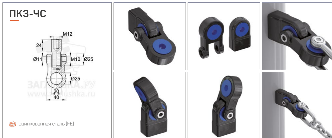
Поворотный стальной подвес. Имеет пластиковые съёмные втулки с внутренним Ø10 мм. В изделии предусмотрено отверстие для крепления с резьбой M12.
