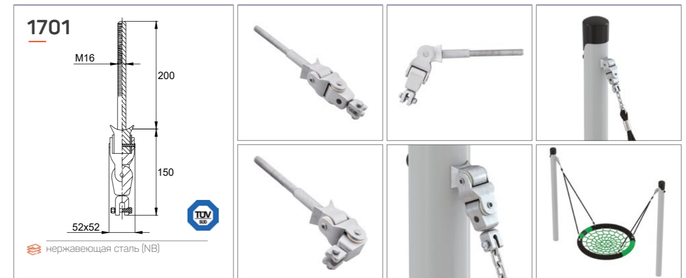
Крепление из нержавеющей стали для подвесных качелей с резьбовой шпилькой M16x200 мм. Изделие применяется с качелями типа «гнездо» (арт. ИЗКНТ-00140, ИЗКНТ-00142, КН-00353, ИЗКНТ-00034).
