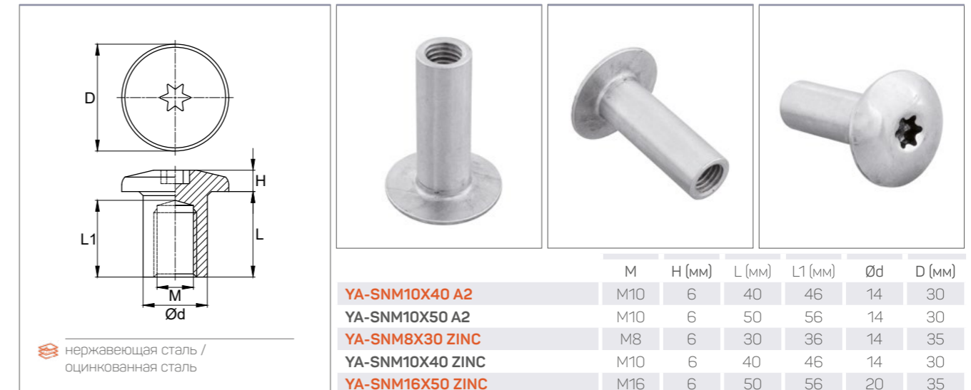
Гайка Эриксона с плоской головкой. Изготовлена из нержавеющей стали.
