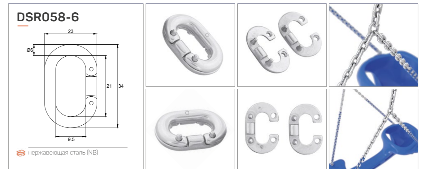
Металлическое соединительное звено цепи. Габариты изделия – 34x23 мм. Диаметр звена – 6 мм. Используется как соединительный элемент в подвесах для качелей.
