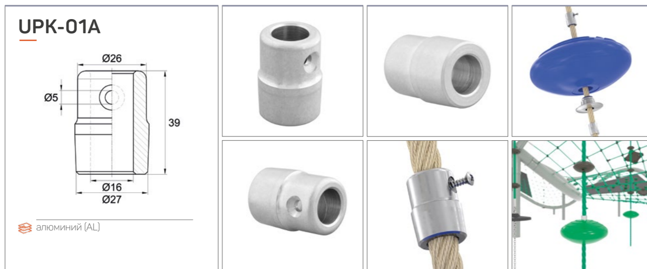
Металлическая фиксирующая втулка. Изготовлена из алюминиевого сплава. Размер изделия – 39x27 мм. Подходит для использования с канатом Ø16 мм.
