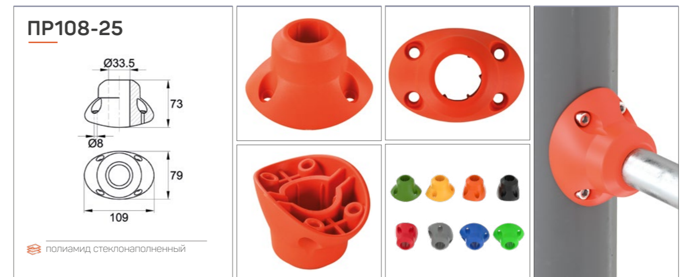
Переходник из стеклонаполненного полиамида для трубы диаметром 108 мм и трубы ДУ25. Размер изделия – 109x79x73 мм.
