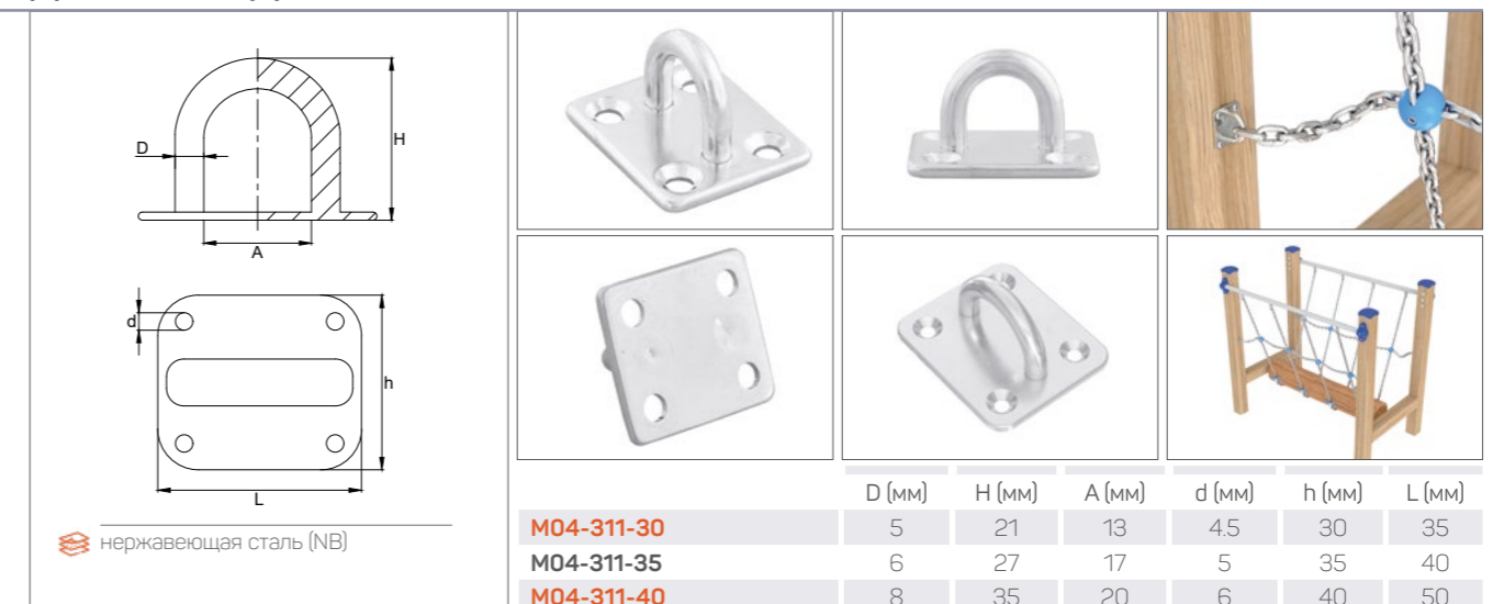
Бортовая скоба. Изготовлена из нержавеющей стали. Размер изделия может быть 30x35, 35x40 и 40x50 мм. Рекомендуемый предел рабочей нагрузки составляет 330 кг.
