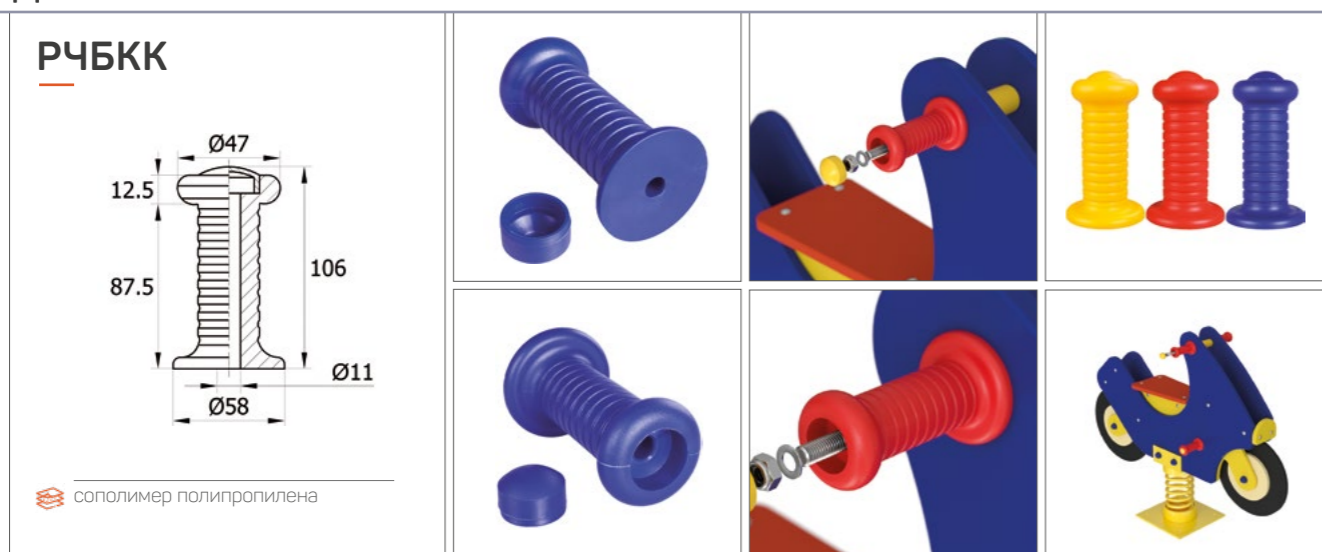
Рифлёная ручка для детского балансира. Имеет отверстие для крепления Ø11 мм. Длина изделия – 106 мм.
