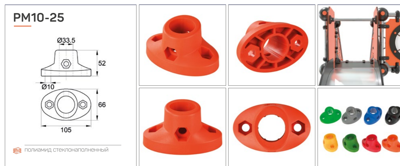
Переходник для крепления трубы ДУ 25 (Ø33,5 мм) к плоской поверхности.
