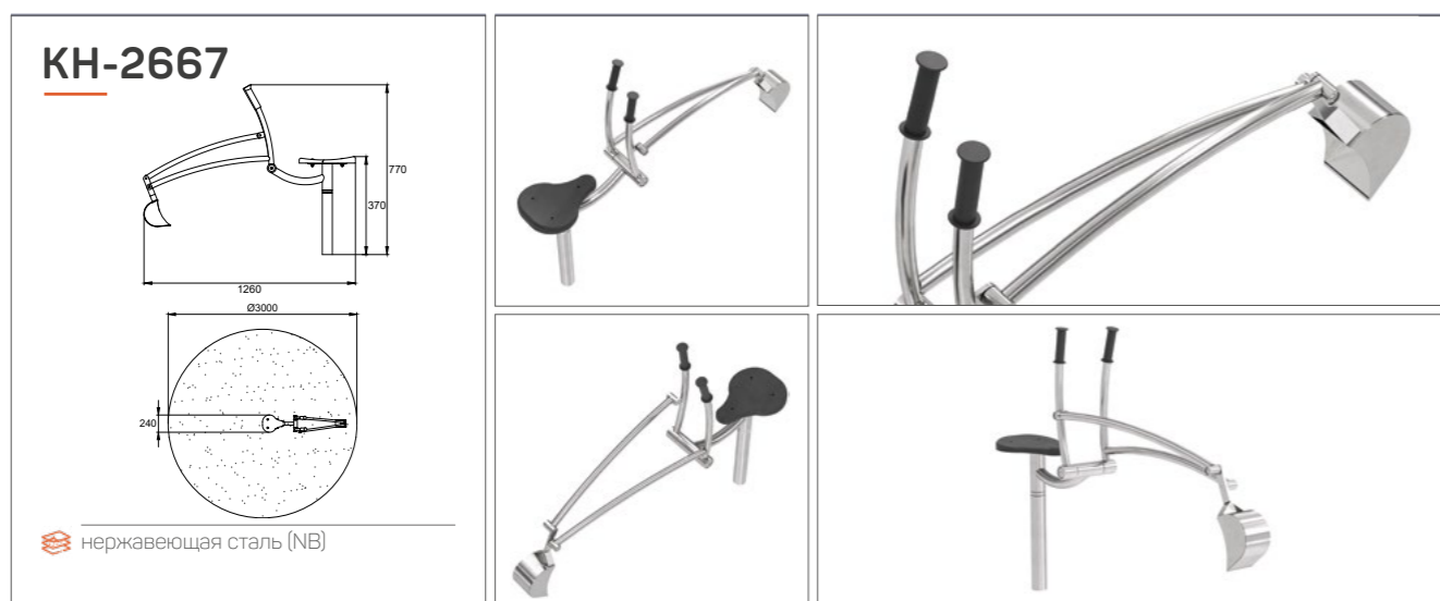
Конструкция «Экскаватор». Изготовлена из нержавеющей стали. Общая длина — 3000 мм.
