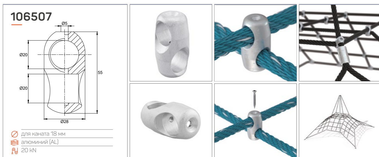
Алюминиевый крестообразный соединитель для двух канатов Ø18 мм. При сборке канаты пропускаются в отверстия соединителя и фиксируются саморезом. Для более надёжного соединения изделие можно обжать 300-тонным прессом.
