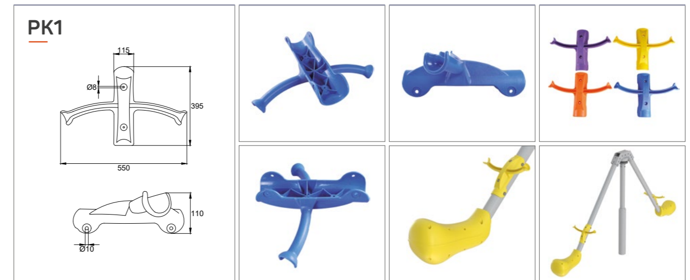
Ручка для карусели/балансира под трубу Ø108 мм. Габариты изделия – 550x395x110 мм.
