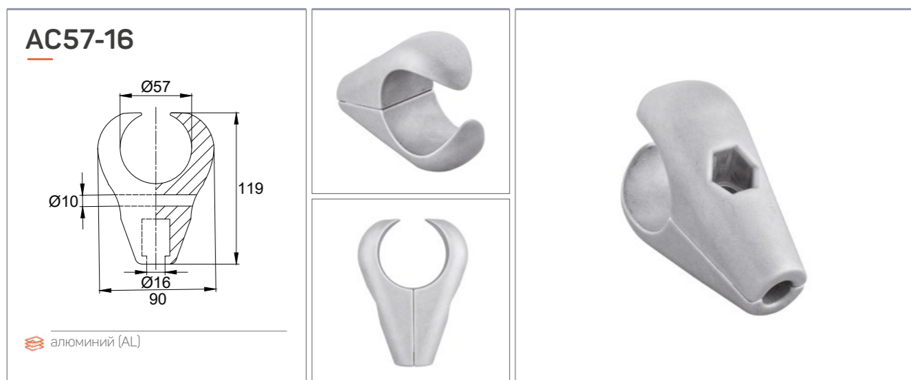
Алюминиевый полухомут для фиксации каната Ø16 мм к трубе Ø57 мм.
