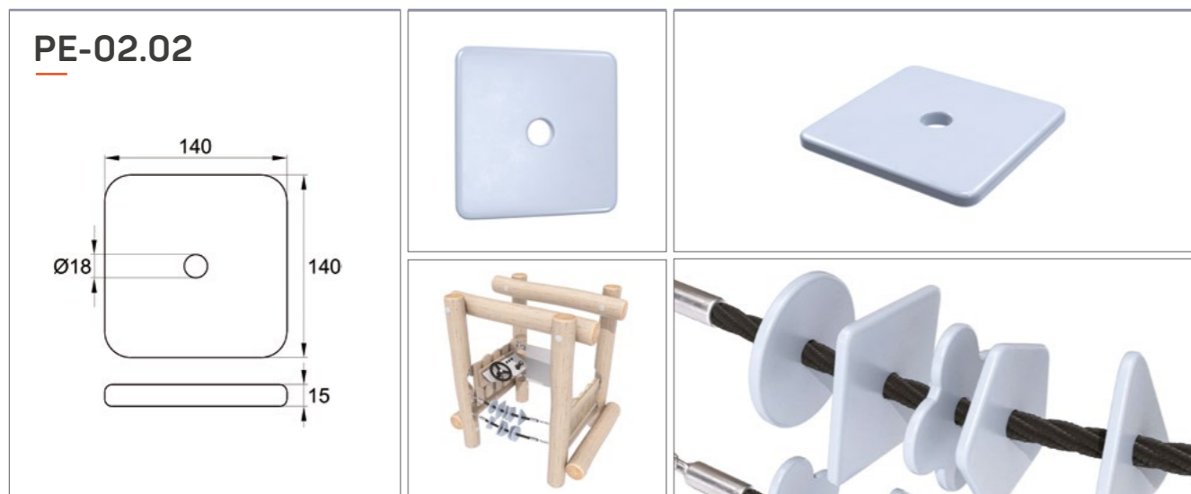
Пластиковая фигура «Счёты» квадратной формы. Габариты изделия – 140x140 мм. Диаметр отверстия под канат – 18 мм.
