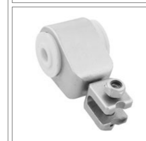
Универсальное крепление из нержавеющей стали для качелей. Используется совместно с П-образным кронштейном. В комплект поставки входят полиамидная вставка и крепежная фурнитура из нержавеющей стали: болт DIN933 M8x30 и гайка DIN985 M8.
