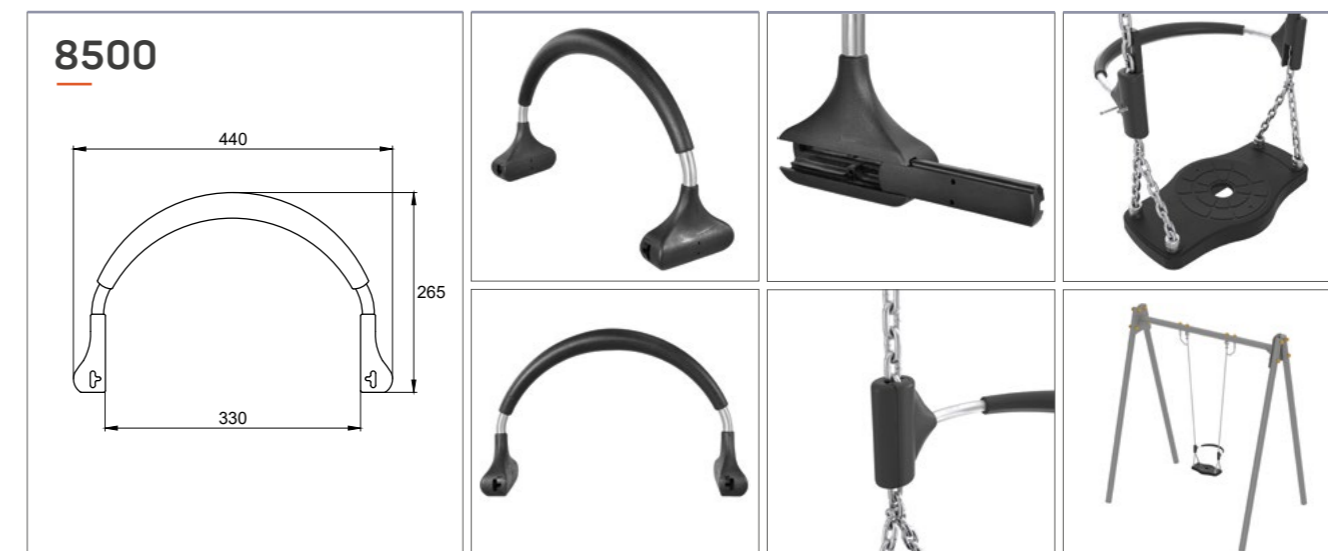
Спинка/защитный бортик для качелей. Габариты – 440x265 мм. Состоит из стальной нержавеющей трубки, частично покрытой полиуретаном. Изделие предназначено для использования совместно с цепью DIN766 с диаметром прутка 6 мм.
