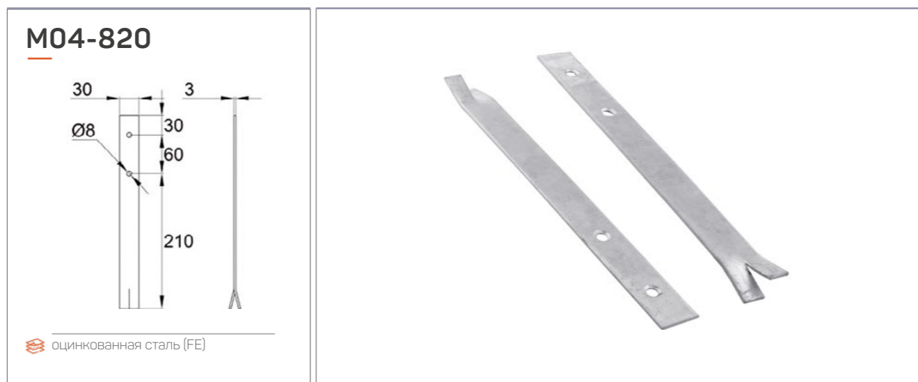
Грунтовый анкер. Изготовлен из оцинкованной стали. Габариты изделия – 210x30x3 мм.
