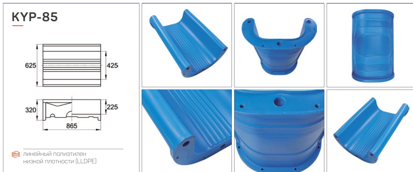
Сегмент пластиковой горки. Внешние габариты – 865х625 мм. Внутренняя ширина изделия – 425 мм.
