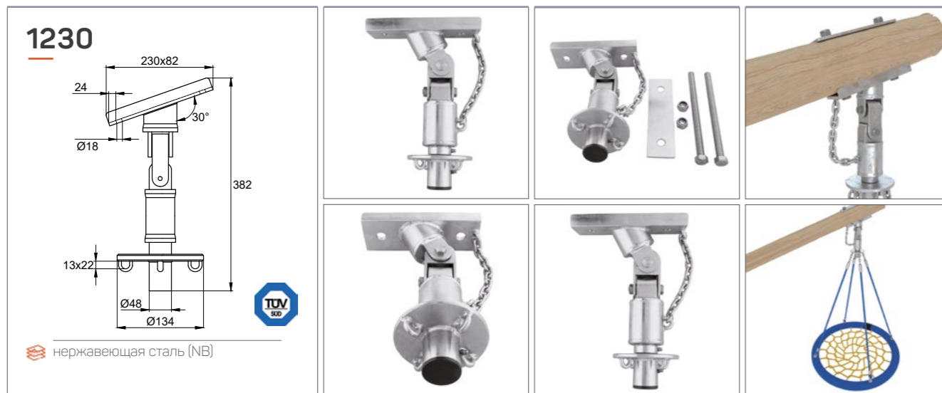
Шарнирное крепление из нержавеющей стали для подвесных качелей. Обеспечивает раскачивание в четырёх плоскостях и вращение на 360°. Крепится при помощи болтов M16x250 мм (класс A2). Применяется с качелями типа «гнездо» (арт. ИЗКНТ-00140, ИЗКНТ-00142, КН-00353, ИЗКНТ-00034).
