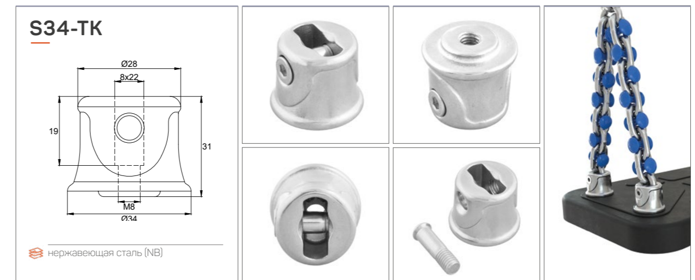
Соединитель для крепления качелей. Поставляется в комплекте с винтом М8. Предназначен для фиксации металлических подвесов к плоскому сиденью качелей. Изделие может использоваться для установки сидений BASIC и FORTO, а также для сиденья анатомической формы (арт. СДЗЧК).
