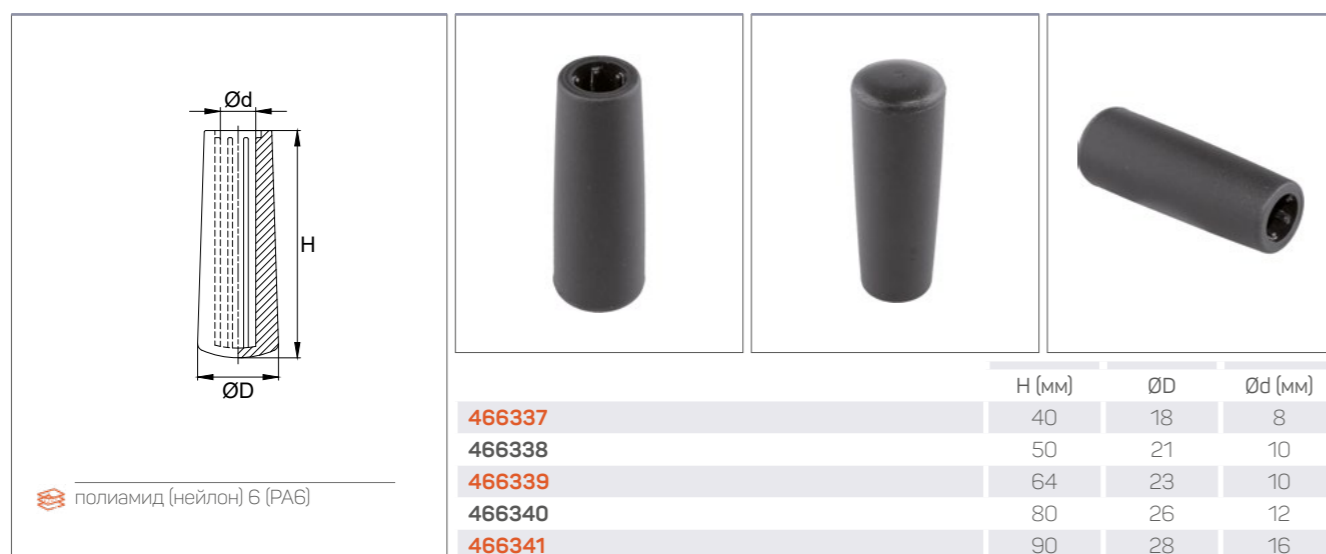
Ручка без сквозного отверстия под трубу Ø8, 10, 12 или 16 мм.
