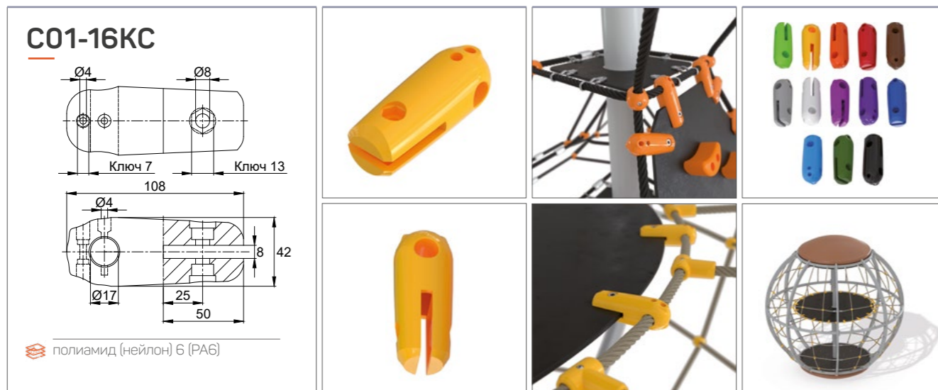
Разборный пластиковый соединитель для Т-образной фиксации каната Ø16 мм к резиноканевой ленте. Состоит из двух элементов. Фиксируется при помощи винта М4. Выдерживает нагрузку до 12 кН.
