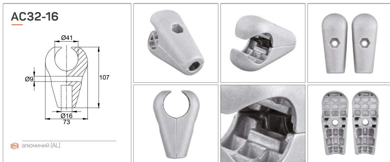
Алюминиевый полухомут для фиксации каната Ø16 мм к трубе ДУ32.
