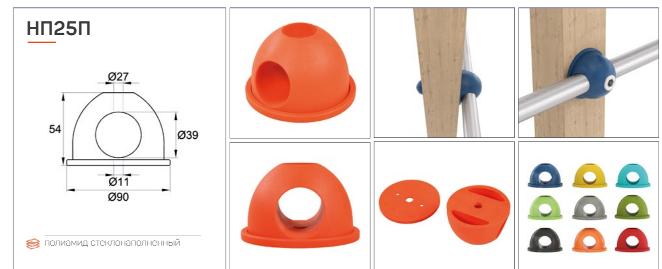
Переходник-накладка на трубу ДУ25. Состоит из двух частей. Габариты изделия – 90x54 мм.
