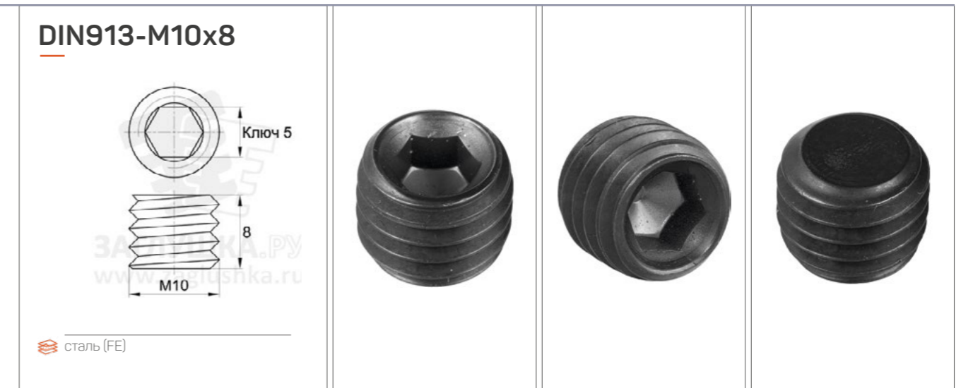
Стальной установочный винт с резьбой M10x8 мм и внутренним стальным шестигранником под ключ. Стандарт DIN913.
