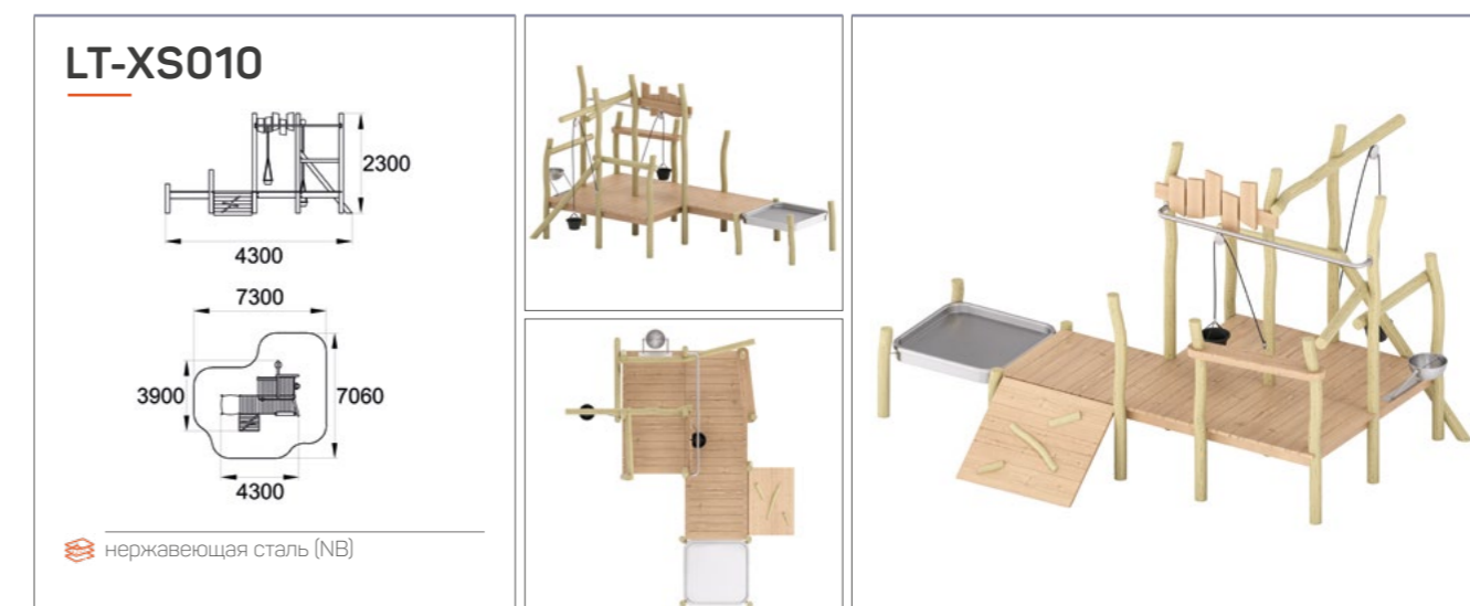
Детский комплекс для игры с водой и песком. Габариты – 4300x2300x3900 мм. Состоит из деревянного каркаса, резиновых вёдер и ёмкостей из нержавеющей стали.
