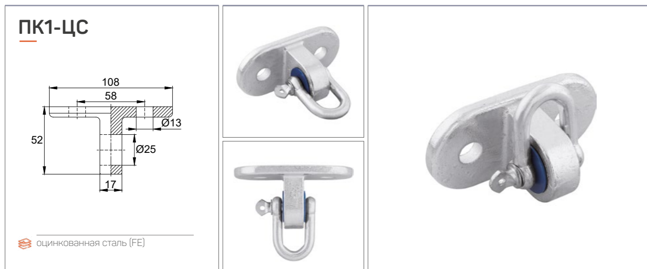
Подвес из оцинкованной стали с пластиковыми съёмными втулками Ø10 мм. Изделие крепится к ровной поверхности при помощи болтов M12. В комплекте поставляются такелажная скоба и винтовой палец.
