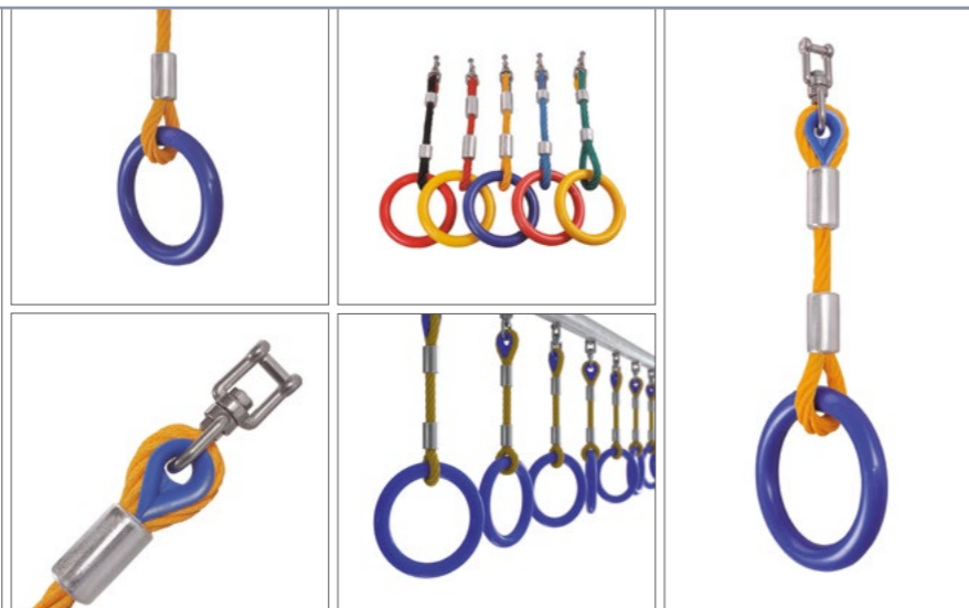
Гимнастическое кольцо круглой формы с подвесом из армированного каната Ø16 мм. Длина подвеса – 300 мм. Крепится с помощью вертлюга.
