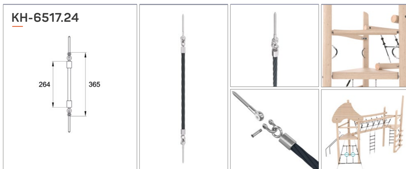
Стропа-ручка длиной 365 мм. Состоит из 6-прядного каната диаметром 16 мм, двух алюминиевых втулок и двух метрических колец.
