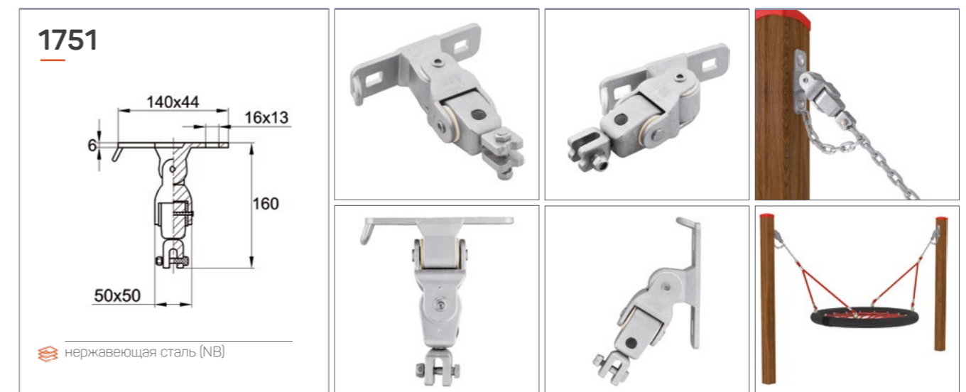
Крепление из нержавеющей стали для подвесных качелей. Крепится к плоской поверхности при помощи двух болтов M12 (класс A2 или A4). Изделие применяется с качелями типа «гнездо» (арт. ИЗКНТ-00140, ИЗКНТ-00142, КН-00353, ИЗКНТ-00034).
