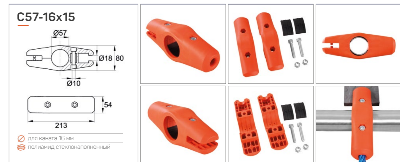
Пластиковый хомут для соединения трубы диаметром 57 мм с канатом Ø16 мм и листовым материалом толщиной 15 мм. Размер изделия – 213x54x80 мм.
