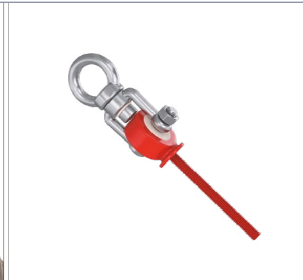
Адаптер из нержавеющей стали с полиамидной втулкой. Резьба – M12x170мм. Поставляется в сборе с кольцом-скобой М8 (арт. KTSES).
