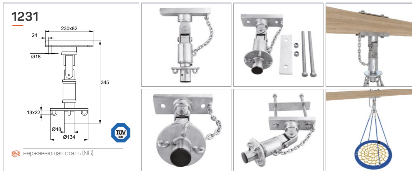
Шарнирное крепление из нержавеющей стали для подвесных качелей. Обеспечивает раскачивание в четырёх плоскостях и вращение на 360°. Крепится при помощи болтов M16x250 мм (класс A2). Применяется с качелями типа «гнездо» (арт. ИЗКНТ-00140, ИЗКНТ-00142, КН-00353, ИЗКНТ-00034).
