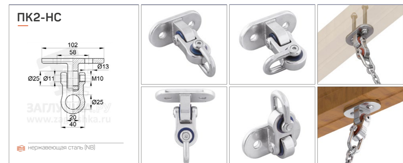
Поворотный подвес из нержавеющей стали. Имеет пластиковые втулки с внутренним Ø10 мм. Крепится к поверхности при помощи двух болтов M12.
