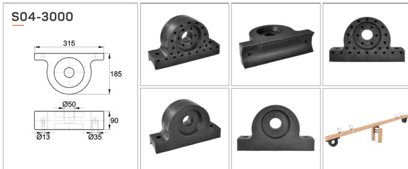
Резиновый отбойник размером 315x185 мм для балансиров. Фиксируется к трубе при помощи винтов и гаек М10 или круглому брусу саморезами диаметром до 10 мм.
