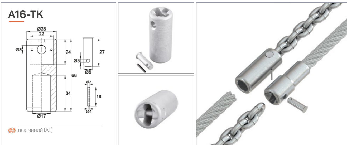
A16-TK Алюминиевая обжимная гильза для соединения каната Ø16 мм. Обжимается 300-тонным прессом. Может использоваться в подвесах качелей при установке игровых канатных конструкций.
